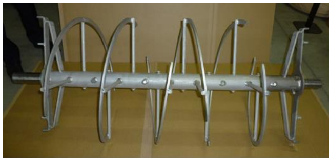
図1 開発された攪拌効率の良い、強化型のスクリュー
