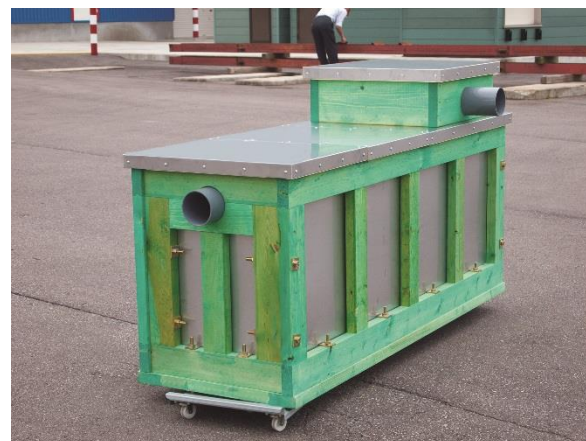
新浄化装置 SG-500 型 容量500リットル
