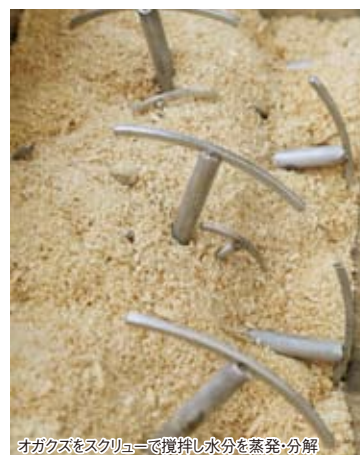
オガクズをスクリーンで攪拌し水分を蒸発・分解
