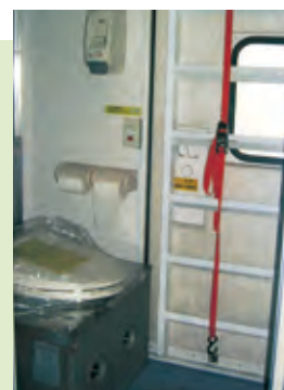
■車いすに対応(車いす用パワーリフト搭載(荷重量300kg))
