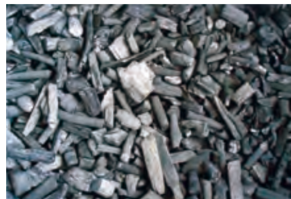
■備長炭が汚水を浄化します(SG500型は60kg)
