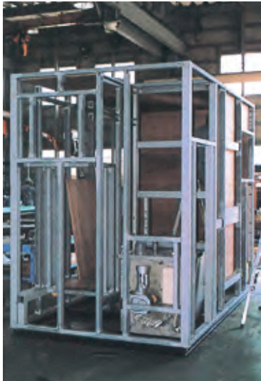
■鉄骨フレームにバイオトイレが内蔵されています。
